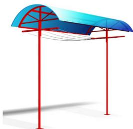
Конструкция довольно простая и не дорогая. Нет смысла использовать большие профильные трубы с толстыми стенками. В нашем исполнении для столбов будет использована профильная труба 40x40x2. Для всего остального профиль 20x20x2 или 25x25x2. На картинке использован тонированный поликарбонат 4 мм. Однако мы предпочитаем не использовать поликарбонат толщиной менее 6 мм. Так же когда мы делаем любой [навес или козырек](#) мы используем универсальные термошайбы, соединительные и торцевые планки.
